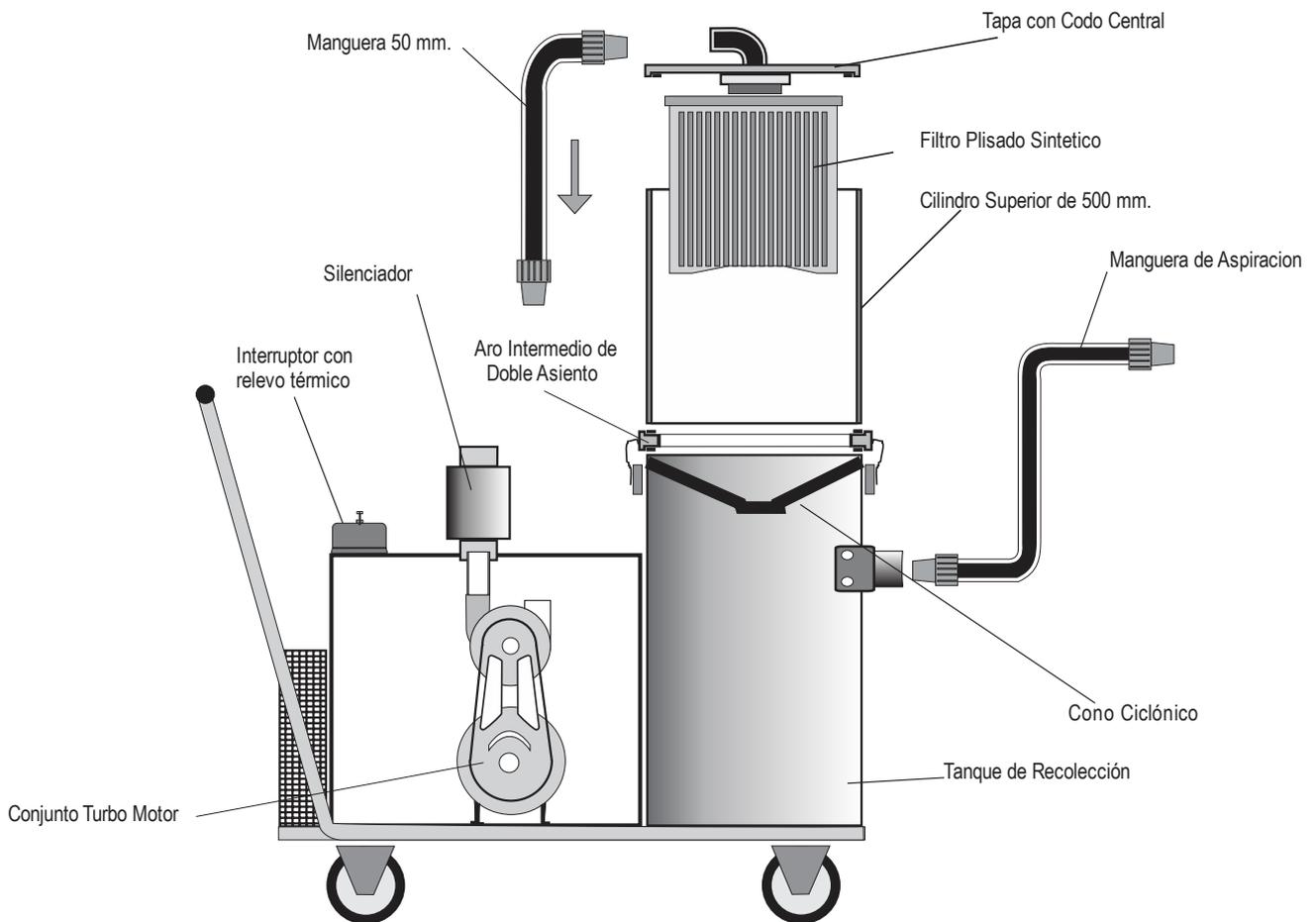
**Máquina compuesta por un conjunto turbo-motor,
