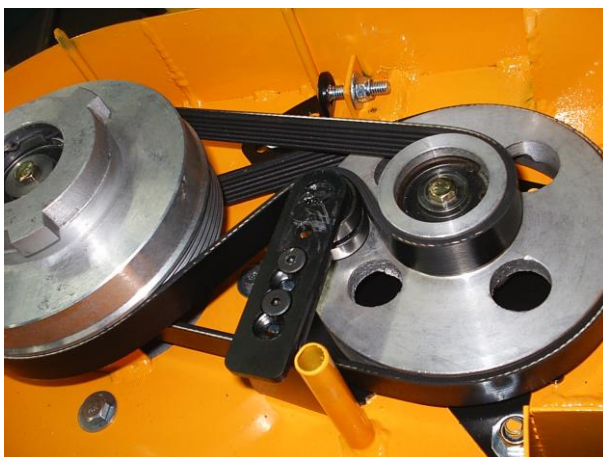
DISPOSITIVO TENSOR DE CORREA
