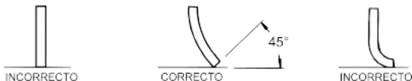
Para ajustar el ángulo de la boquilla, gire la perilla que se encuentra en la parte superior del soporte de la misma. Girando en sentido horario se elevan los extremos de la boquilla y baja el centro – se debe hacer este ajuste si el equipo seca bien en los extremos pero deja sin secar la zona central. Girando la perilla en sentido anti-horario bajan los extremos y se eleva el centro – se debe hacer este ajuste si el equipo seca bien en la zona central pero deja sin secar los extremos.
