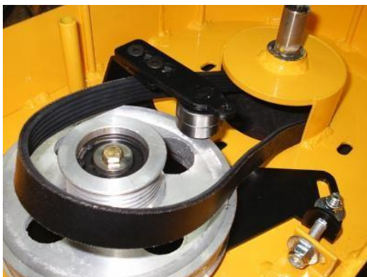
La correa inferior (6PK698) ubicada para poner motor
