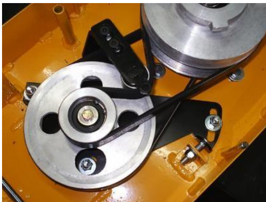
Dar tensión y fijar bulones
