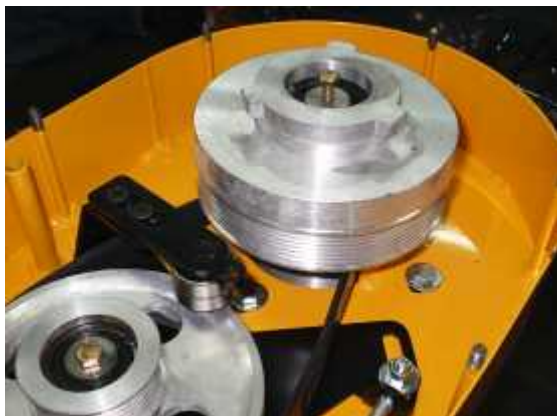
Colocación de Polea Tractora para fijarla con su bulón.
