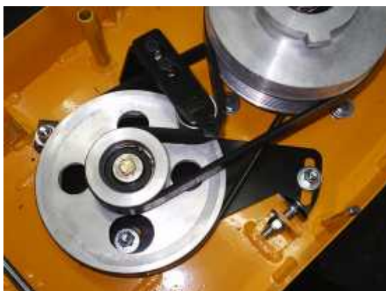
Dar tensión y fijar bulones
